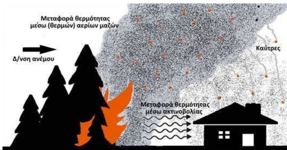
Σχέδιο 3. Τρόποι ροής της θερμότητας σε μια δασική πυρκαγιά, που εξελίσσεται πλησίον κτιρίου και απεικόνιση πιθανού τρόπου μετάδοσης δασικής πυρκαγιάς με μεταφερόμενες καύτρες σε κτίρια παρουσία μέτριου άνεμου
