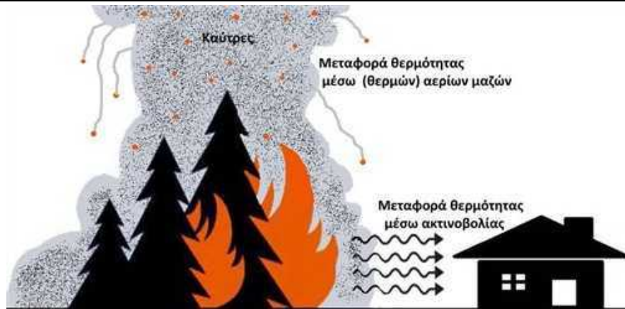
Σχέδιο 2. Τρόποι ροής της θερμότητας σε μια δασική πυρκαγιά, που εξελίσσεται πλησίον κτιρίου και απεικόνιση πιθανού τρόπου μετάδοσης δασικής πυρκαγιάς με μεταφερόμενες καύτρες σε κτίρια χωρίς την παρουσία άνεμου υπό συνήθες πρόσκαιρης νηνεμίας, ή ατμοσφαιρικής ευστάθειας
