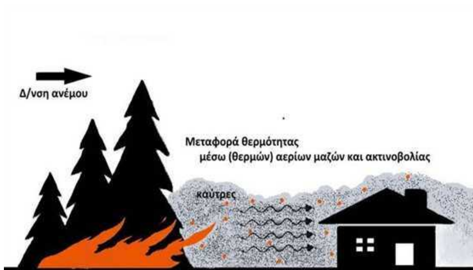
Σχέδιο 4. Τρόποι ροής της θερμότητας σε μια δασική πυρκαγιά, που εξελίσσεται πλησίον κτιρίου και απεικόνιση πιθανού τρόπου μετάδοσης δασικής πυρκαγιάς με μεταφερόμενες καύτρες σε κτίρια παρουσία ισχυρού άνεμου
